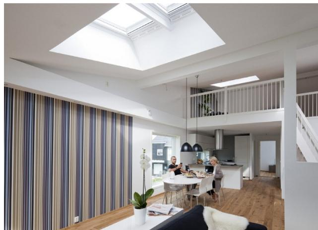
Tanto las ventanas para techos como los túneles solares, pueden instalarse en techos plano. Sólo debe prever la banquina con los 15° mínimos de pendiente requeridos para el efectivo escurrimiento del agua.
