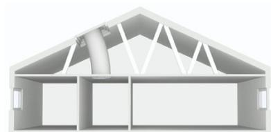
Para distancias más largas entre cielorraso y techo puede instalar un túnel solar..
