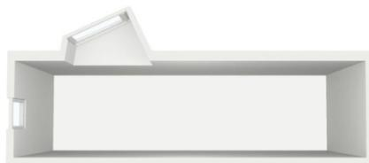
Cuando tengo un techo plano se debe elevar la ventana o el túnel solar al menos 15° mediante una cuña./banquina.
