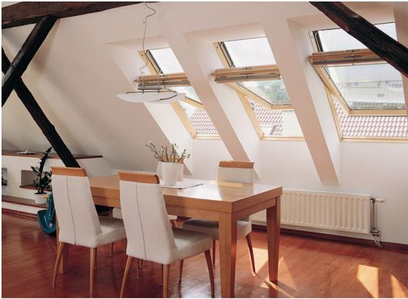
Colocando una fuente de calor debajo de la ventana se obtiene la **mejor distribución** del calor y se requiere de **menos energía** para calentar una habitación.
